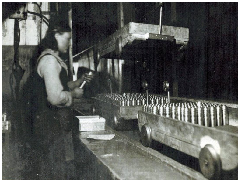
Конвейер подачи 37 мм снарядов к военной приемке
